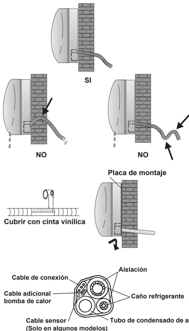
La correcta instalación del drenaje de condensado, es un punto fundamental de la instalación del equipo.
