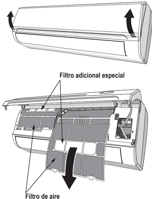
Mantener limpio el filtro de aire es fundamental para conservar el rendimiento y vida útil de su equipo.
