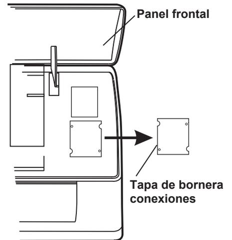
**Nota:** En los modelos sin bornera de entrada, los cables han sido conectados en fábrica a la plaqueta de control.
